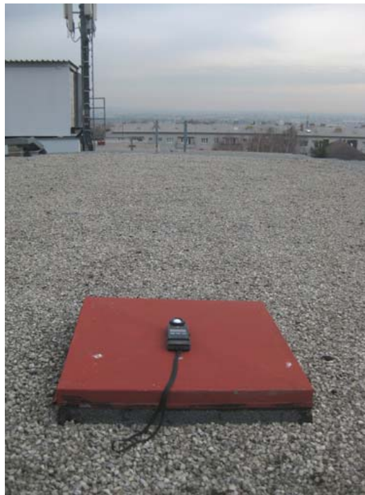
Abbildung 6: Messung der äußeren Beleuchtungsstärke auf dem Dach
