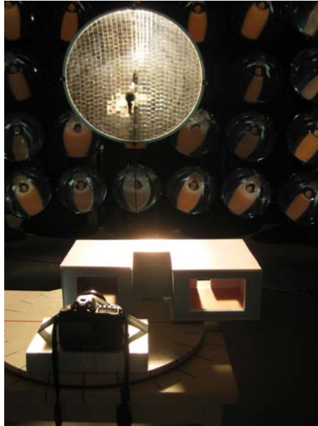
Abbildung 22: Geräteanordnung für Modellaufnahmen im Lichtlabor; künstliche Sonne, Modell, Kamera
