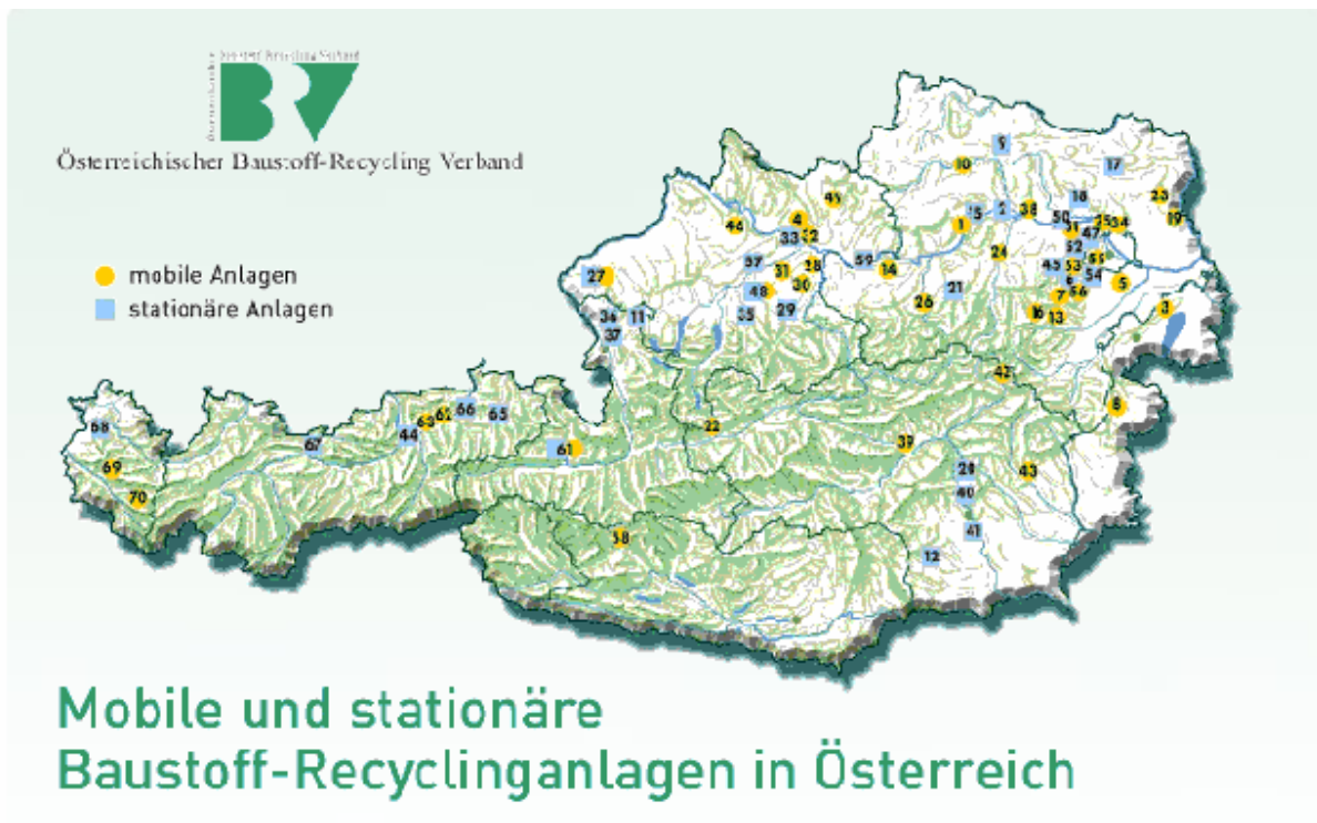
Abbildung 14: Mobile und stationäre Baustoff-Recyclinganlagen in Österreich laut BRV
