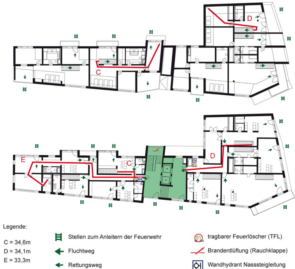
Abbildung 5: Exemplarische Fluchtweglängen / zweiter Rettungsweg / Wandhydranten und Feuerlöscher der Maissonetten im sechsten und siebenten oberirdischen Geschoß
