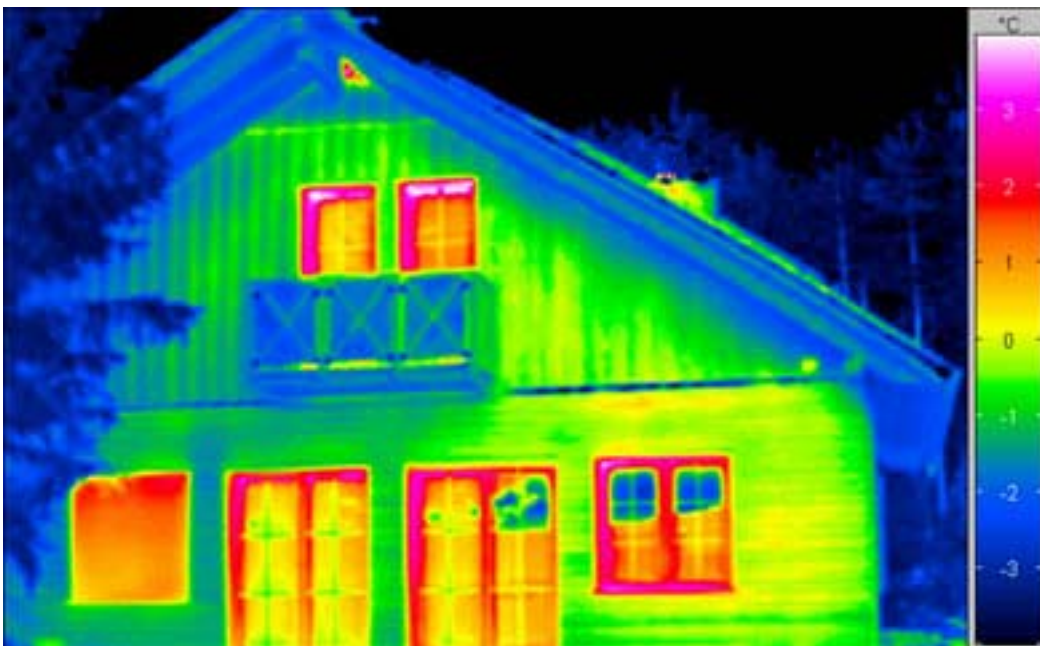
Abbildung 1: Thermogramm eines Einfamilienhauses mit Temperaturskala
