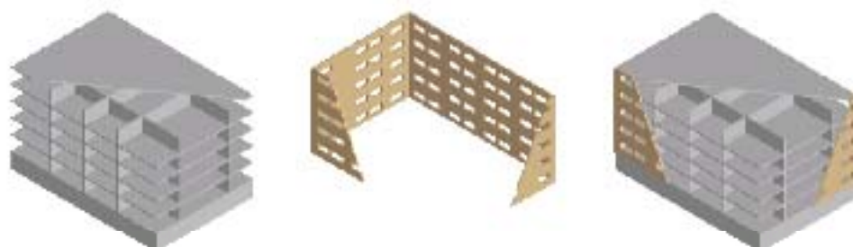
Abbildung 4: Mineralische Tragstruktur mit nichttragenden Holzelementen in der Gebäudehülle
