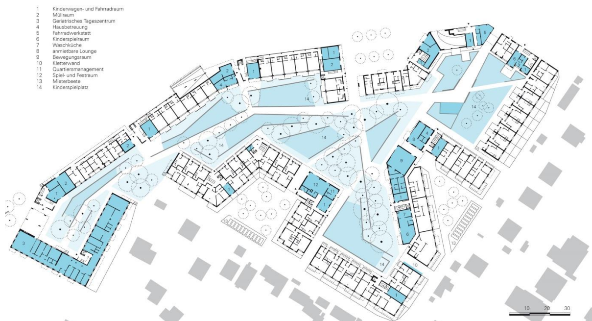
Abb. 17: Bauplatzübergreifende Gemeinschaftsräume im Erdgeschoss der OASE22
