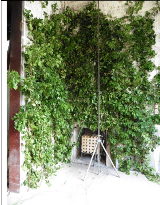
Abbildung 0-1: Efeu am Prüfstand der MA 39 vor der Fassadenbrandprüfung
