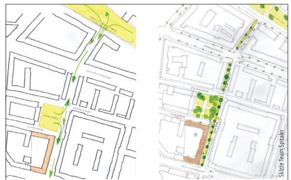
Durchlüftung der Straßenzüge und Rückbau der Straße.
