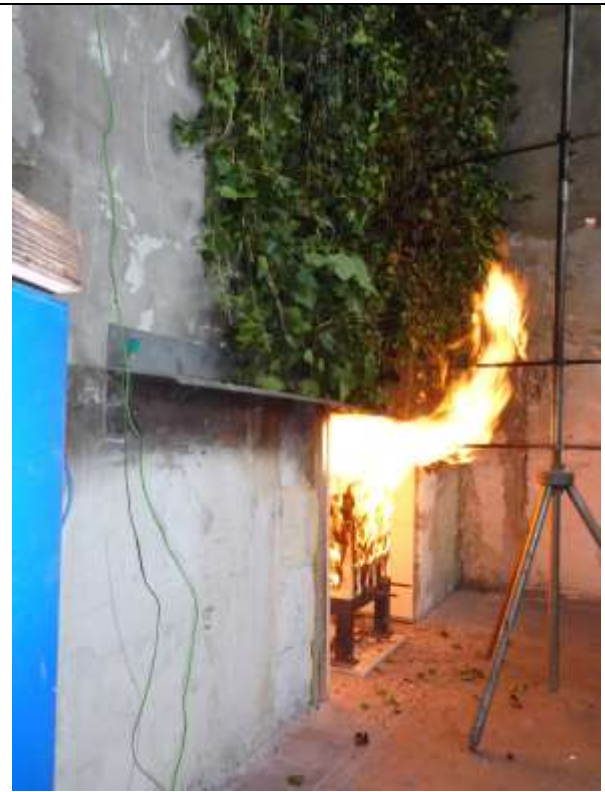
Abbildung 4-10: Fassadenbegrünung während des Versuches (ca. 5,5 Minuten)
