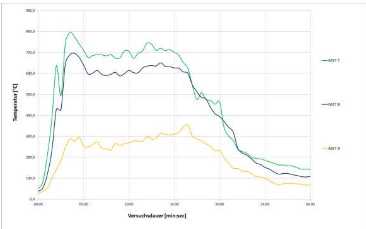
Abbildung 4-54: Temperaturverläufe Messstellen 7 bis 9 (Prüfstandebene), Versuch 5
