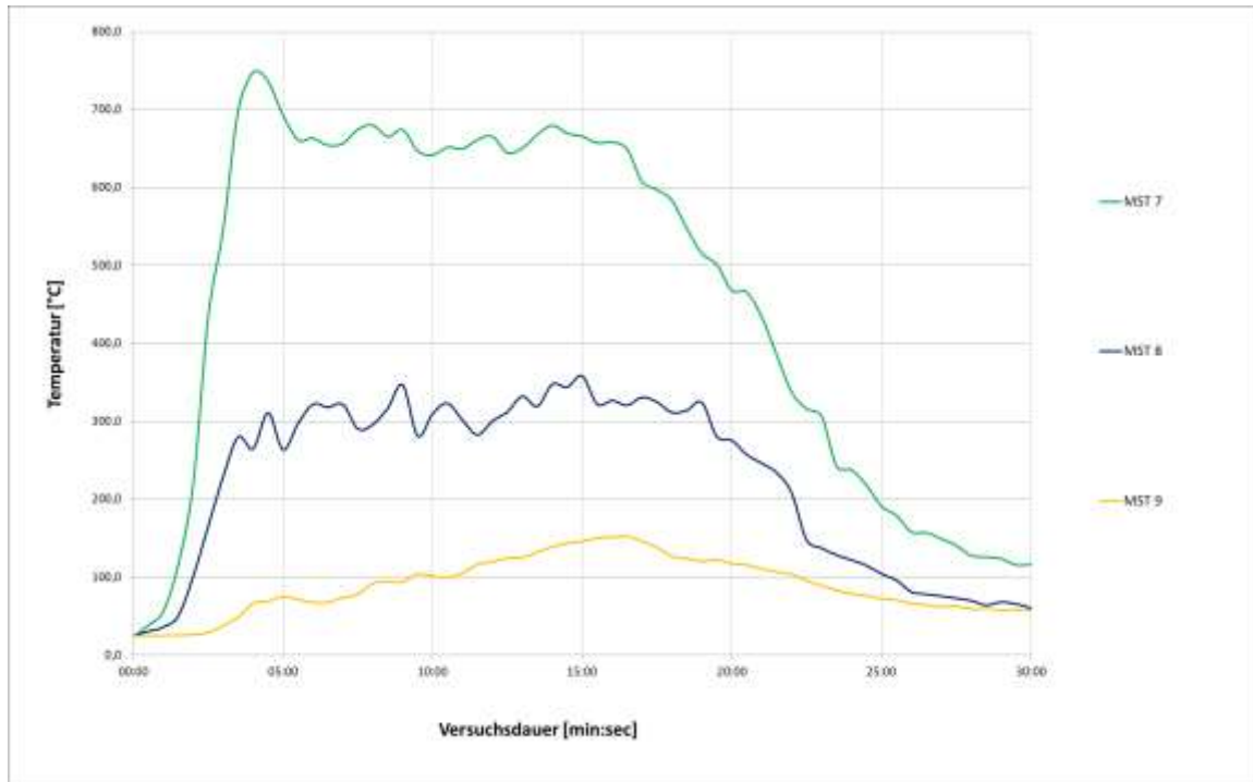
Abbildung 4-45: Temperaturverläufe Messstellen 7 bis 9 (Prüfstandebene), Versuch 5
