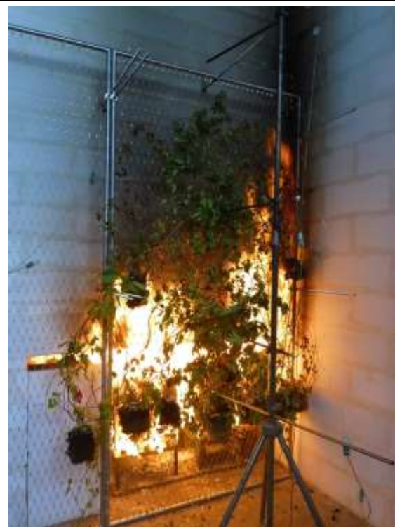
Abbildung 4-66: Fassadenbegrünung während des Versuches (ca. 5 Minuten)
