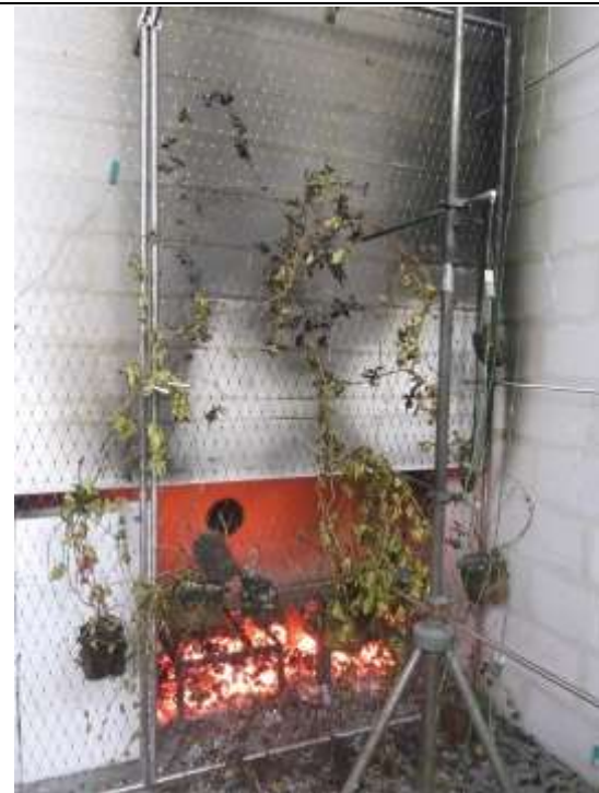
Abbildung 4-68: Fassadenbegrünung nach 30 Minuten der Prüfung - Versuchsende
