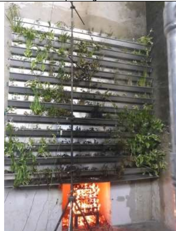
Abbildung 4-29: Fassadenbegrünung zum Ende der Prüfung
