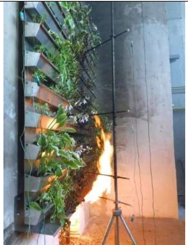
Abbildung 4-28: Flammenhöhe erreicht ca. 1,7 m von Sturzoberkante während der Brandprüfung
