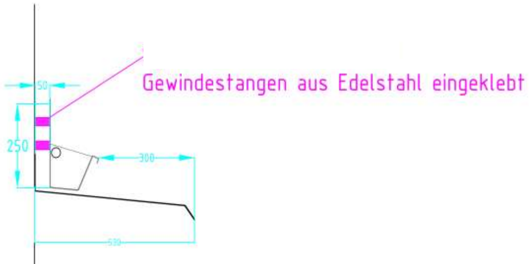
Abbildung 4-13: Skizze der Montage des Aluminiumtrogsystems am Prüfstand, Anordnung der Brandabschottung im Sturzbereich
