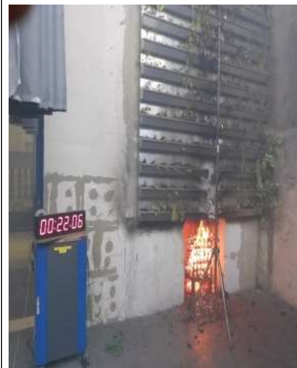
Abbildung 4-37: Fassadenbegrünung zum Ende der Prüfung (Versuchsdauer 22 Minuten)
