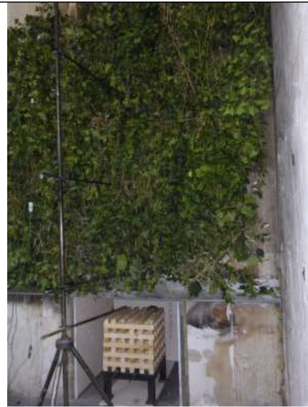
Abbildung 4-9: Grünfassade vor der Fassadenbrandprüfung
