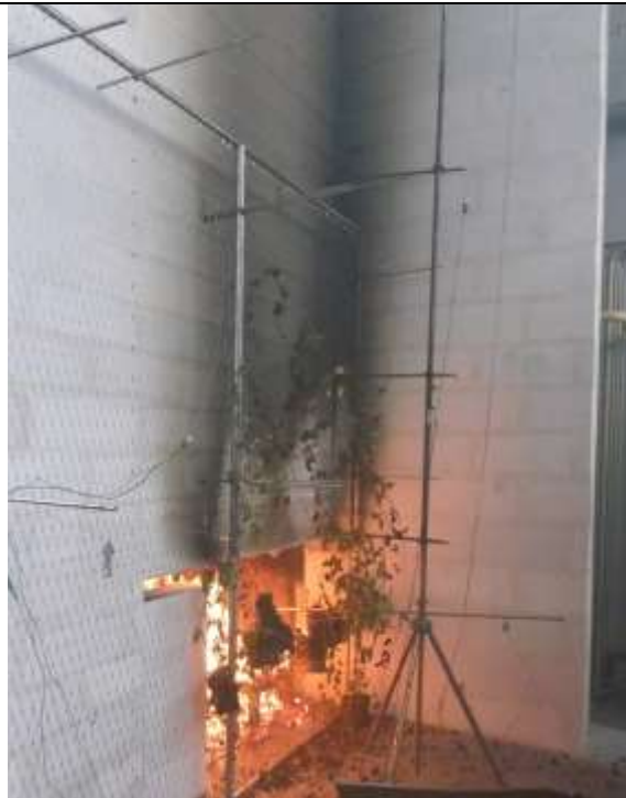
Abbildung 4-67: Fassadenbegrünung zum Ende der Prüfung
