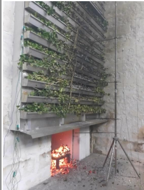
Abbildung 4-40: Fassadenbegrünung zum Ende der Prüfung
