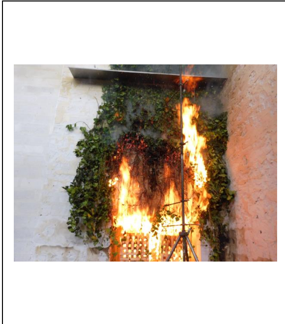
Abbildung 4-7: Flammen erreichen die Edelstahlabschottung (2 Minuten 40 Sekunden)
