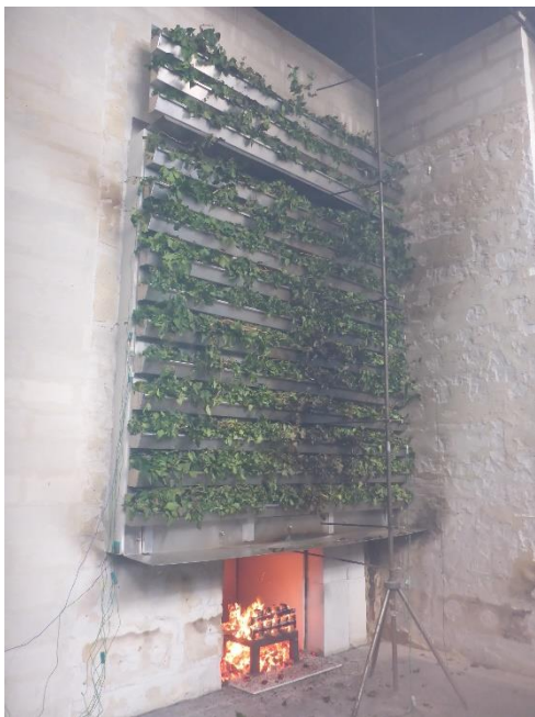
Abbildung 4-50: Fassadenbegrünung zum Ende der Prüfung, nach 21 Minuten
