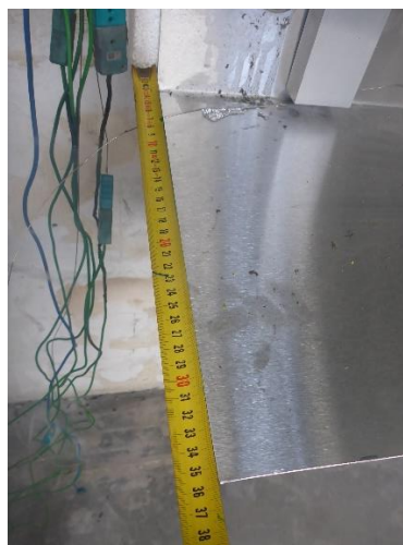
Abbildung 4-41: 360 mm auskragende Brandabschottung
