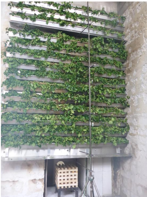
Abbildung 4-48: Fassadenbegrünung unmittelbar vor Versuchsbeginn
