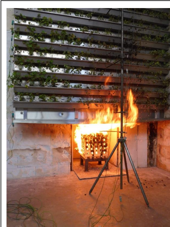
Abbildung 4-25: Fassadenbegrünung während des Versuches nach ca. 7 Minuten
