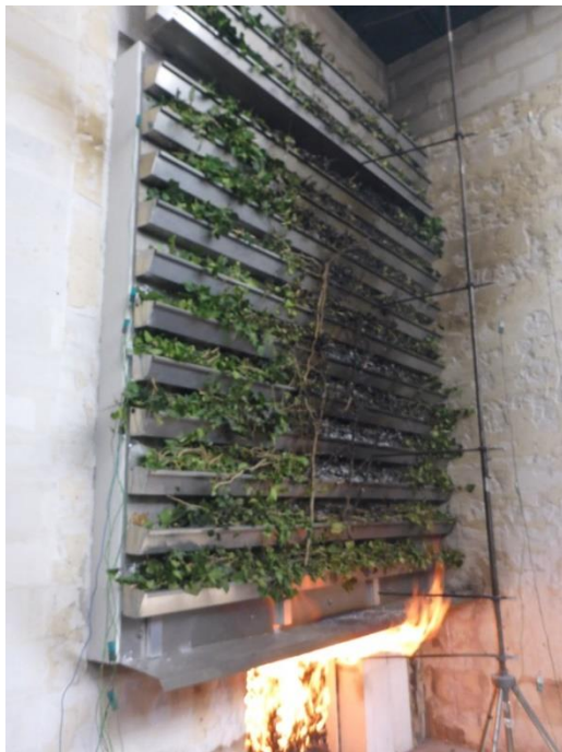
Abbildung 4-37: Grünwandssystem am Prüfstand der MA 39 vor der Fassadenbrandprüfung, Efeu in den freizuhaltenden Bereich oberhalb der Abschottung ragend
