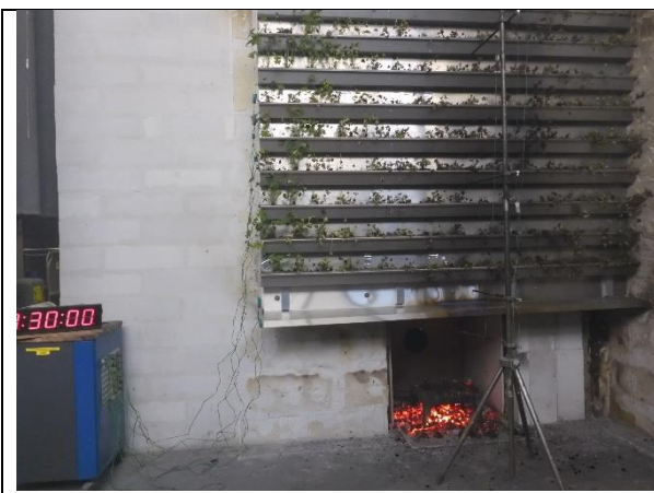
Abbildung 4-25: Fassadenbegrünung während des Versuches nach ca. 7 Minuten
