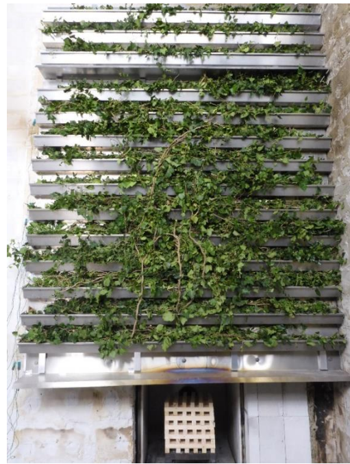
Abbildung 4-37: Grünwandssystem am Prüfstand der MA 39 vor der Fassadenbrandprüfung, Efeu in den freizuhaltenden Bereich oberhalb der Abschottung ragend
