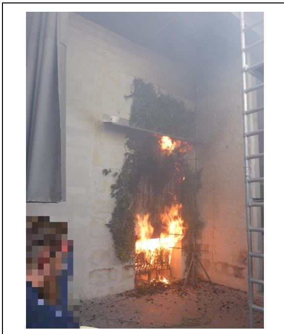
Abbildung 4-9: Brandversuch nach 8 Minuten, durch strohfeuerartigen Mitbrand neuerlich Flammen an der Abschottung
