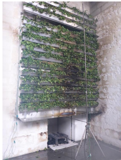
Abbildung 4-51: Fassadenbegrünung nach der Prüfung
