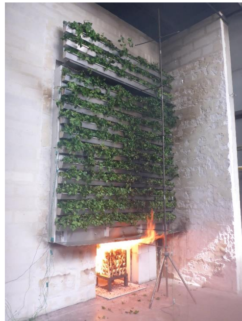
Abbildung 4-49: Fassadenbegrünung während des Versuches (Versuchsdauer ca. 9,5 Minuten)
